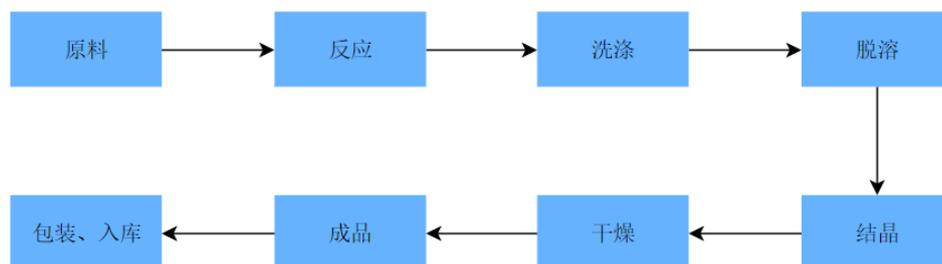
2、原膜散酯（HMS）、奥克立林（OCT）、水杨酸异辛酯（OS）、对甲氧基肉桂酸异辛酯（OMC）、铃兰醛（LLY）、合成茴脑（AT）等液体类产品的主要生产工艺流程如下：
