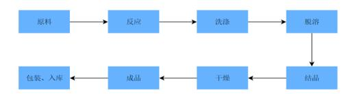
2、原膜散酯(HMS)、奥克立林(OCT)、水杨酸异辛酯(OS)、对甲氧基肉桂酸异辛酯(OMC)、铃兰醛(LLY)、合成茴脑(AT)等液体类产品的主要生产工艺流程如下:
